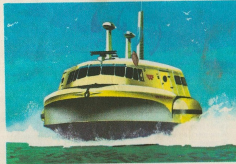
Qu'est-ce? - Ni bateau, ni avion, ni auto, ce SRN 2 est un hovercraft se déplaçant sur coussin d'air, tant au sol qu'en pleine mer (vitesse: 120 km/h - 70 passagers.)
